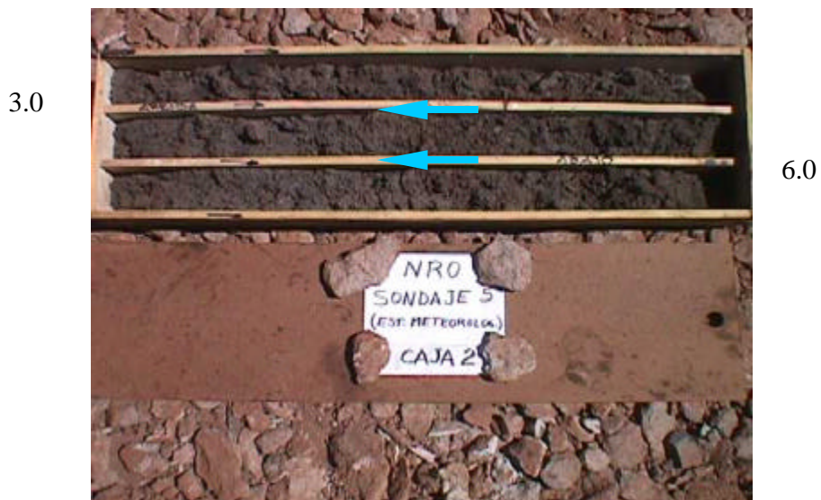
Boring N°5 Box N°2 Depth : 3.0 – 6.0 m
