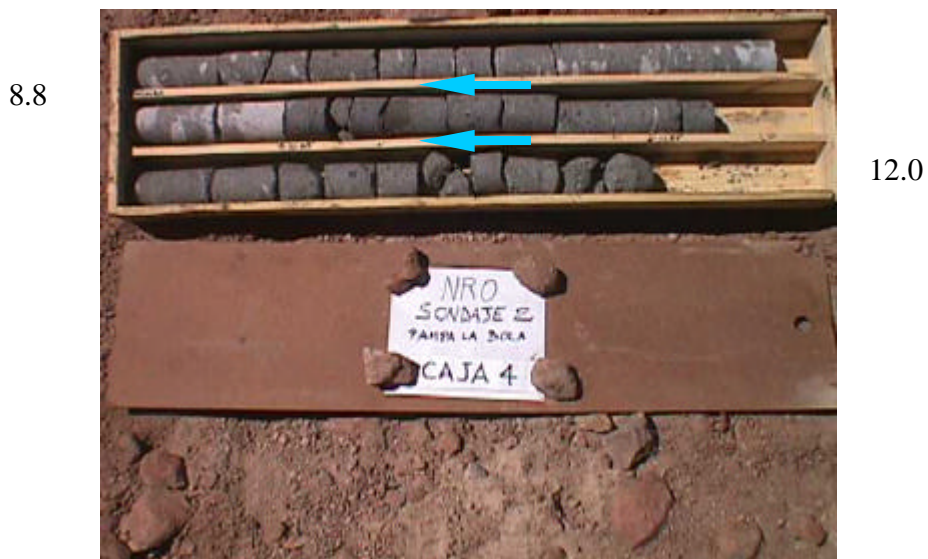
Boring N°2 Box N°4 Depth : 8.8 – 12.0 m
