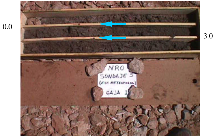
Boring N°5 Box N°1 Depth : 0.0 – 3.0 m
